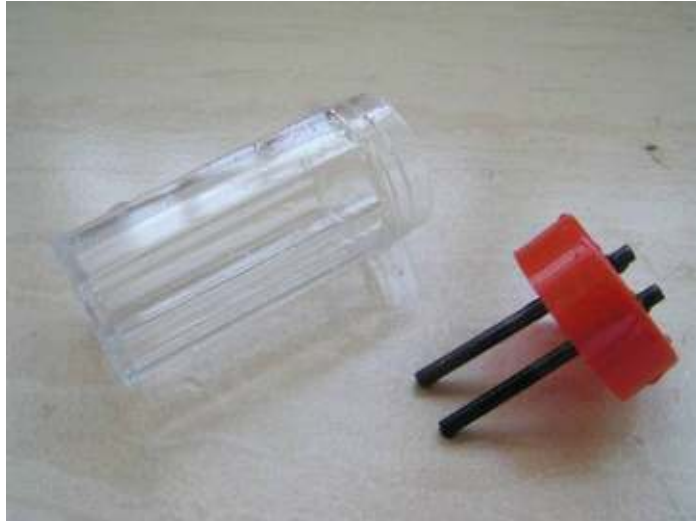
圖 3 利用廢電池碳棒當作電極
