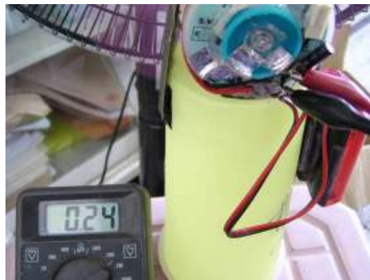
圖 46 產生的電流約 0.24mA
