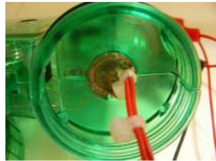
圖 11：將原本電燈的交流電源線引出
