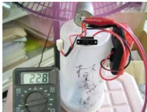
圖 29 產生的電流約 22.8mA
