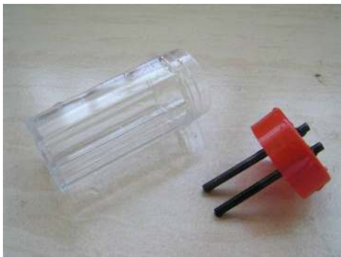
圖 3 利用廢電池的碳棒當作電極
