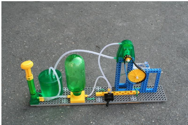
這是個水力發電的模型，左方打氣加壓，產生強力水柱，衝擊水車扇葉，扇葉轉動，便啟動發電機，讓燈泡亮了。這組水力發電的水可流回原位重複利用。
