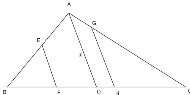
設  $\overline{AD} = x$ ，因為  $\overline{GH} // \overline{AD} // \overline{EF}$ ，所以  $\triangle GHC \sim \triangle ADC$  且  $\triangle ADB \sim \triangle EFB$  ("~"表相似)。
