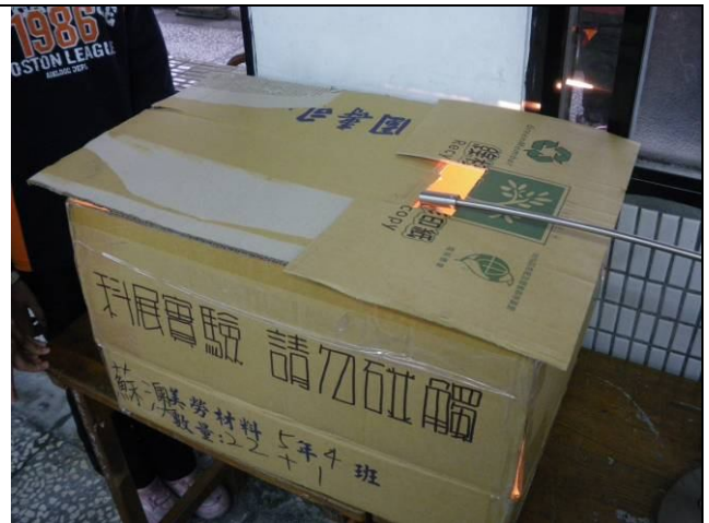
在紙箱上、下及四面加錫箔紙並附加上蓋，溫度快速上升，且突破 30 度。
