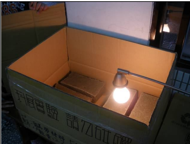
未加錫箔紙溫度上升緩慢，未能突破 30 度
