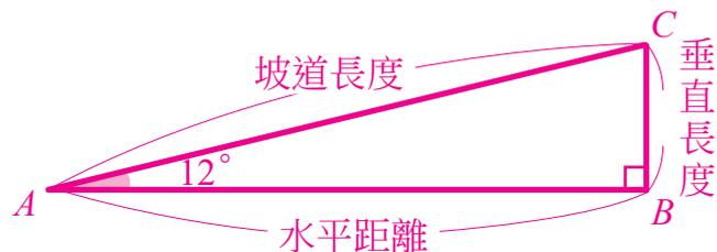
「坡面與水平面夾角 12 度」：坡度約 21%
