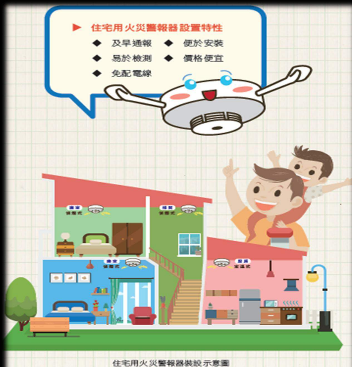
圖 3 住宅用火災警報器裝設示意圖
